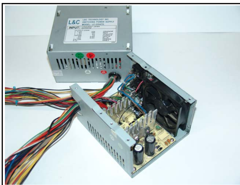
Рисунок 33 – Внешний вид двух импульсных источников питания ПК (на переднем плане крышка блока питания снята)
