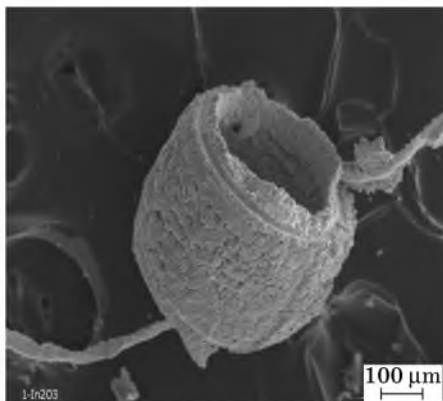
Рис. 5. SEM-изображение чувствительного элемента на основе \text{In}_2\text{O}_3
