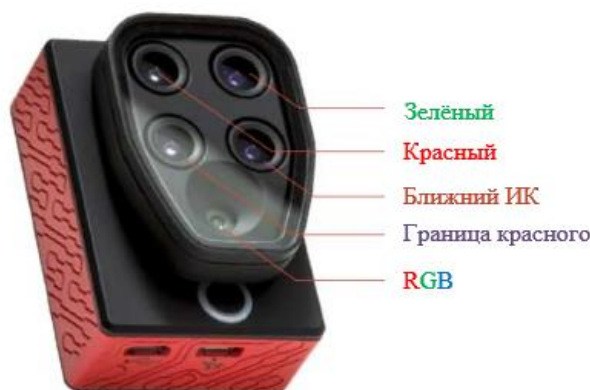
Рисунок 1 – Мультиспектральная камера Parrot Sequoia
