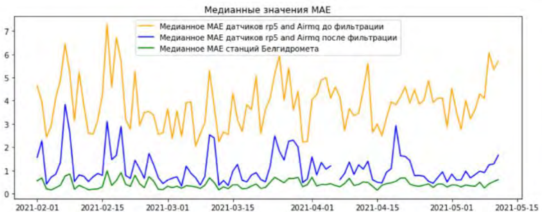
Рис. 3. Медианные значения MAE для данных о температуре воздуха приземного слоя г. Минска за период с 01.03.2021 по 15.05.2021: а) с применением фильтра по MAE; б) без применения фильтра по MAE; в) MAE для АМС Белгидромета
