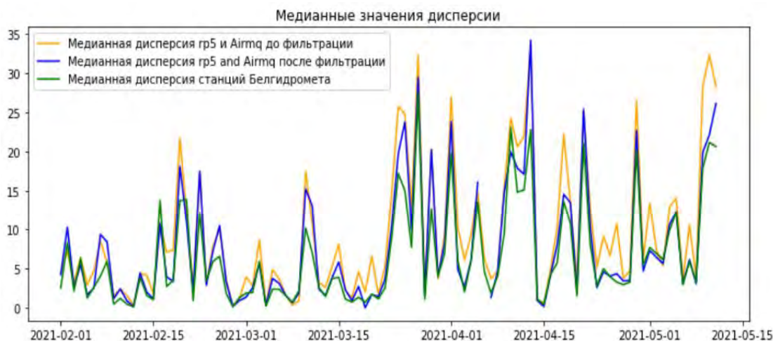
Рис. 4. Медианные значения дисперсии у датчиков после фильтрации, датчиков до фильтрации и датчиков станций Белгидромета за период с 01.03.2021 по 15.05.2021
